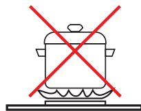
Fond trop petit pour ce brûleur
