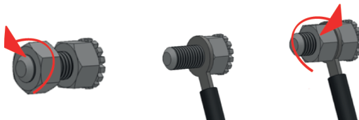
Figura 4. Conexión del equipo a una instalación equipotencial.
